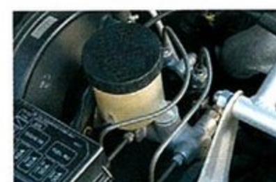
マスターシリンダーの固着で効き応えが悪化
