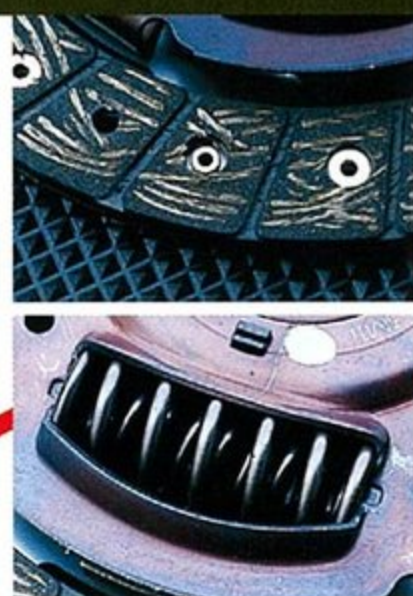
●写真はロードスターターボのクラッチ&クラッチカバー。摩耗材の変更とカバー圧着力がアップされている。ショック吸収スプリングも強化。
