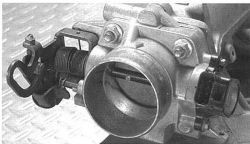
●左が線形、右が非線形のスロットル。非線形はリンク機構を介してスロットルバタフライを作動させる。
